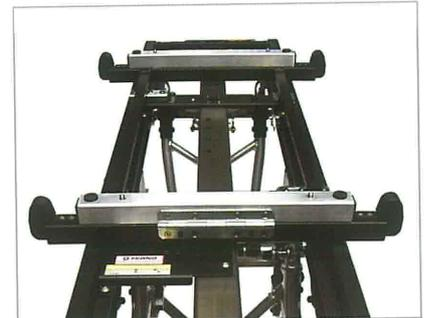
Mit zwei einfachen Handgriffen wird der Sargadapter hoch geklappt. Gegen seitliches Verrutschen sind Dorne eingelassen, die sich in den Holzboden des Sarges drücken. Wir empfehlen als Zubehör zwei Haltegurte zur zusätzlichen Sicherung.
